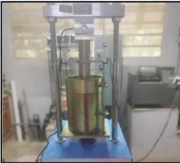
**PRESA ELÉCTRICA PARA ENSAYO CBR**
