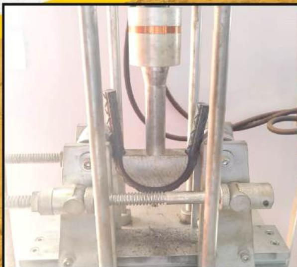
**ENSAYO DE DOBLADO GUIADO DE ACERO**
