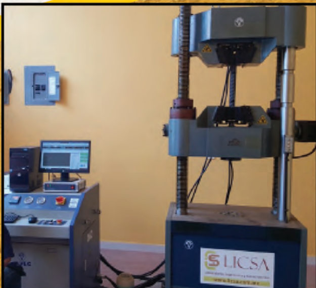
ENSAYO A TENSIÓN DE ELEMENTOS DE ACERO EN PRESA UNIVERSAL
