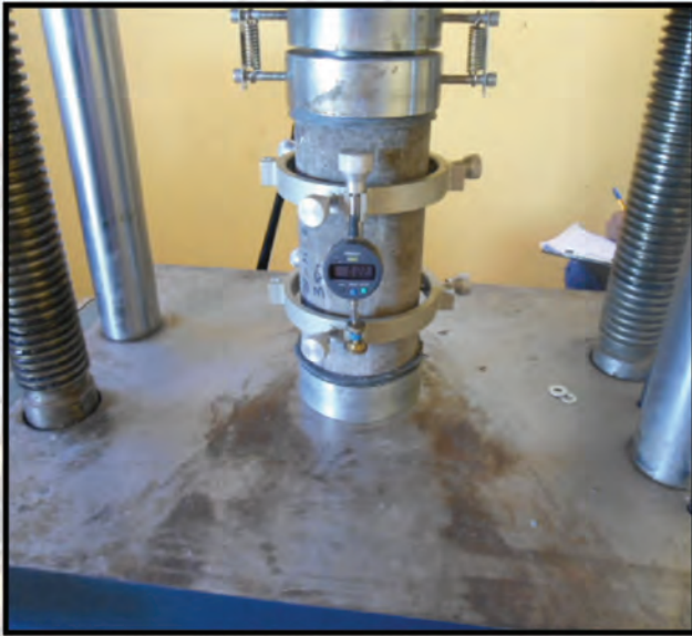
PRUEBA DE DETERMINACIÓN DEL MÓDULO ELÁSTICO DEL CONCRETO ENDURECIDO
