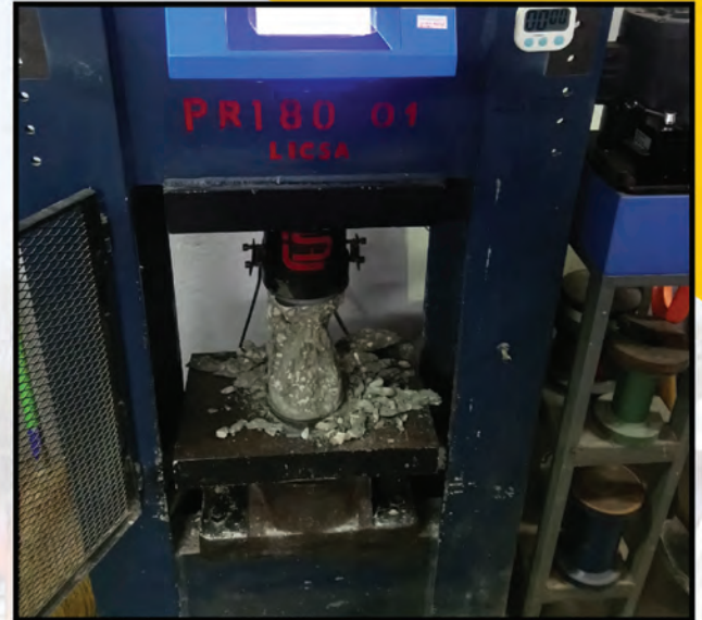
ENSAYO A COMPRESIÓN DE PIEZAS DE CONCRETO EN PRESA HIDRÁULICA ELÉCTRICA
