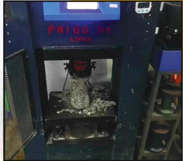
**ENSAYO A COMPRESIÓN DE PIEZAS DE CONCRETO
