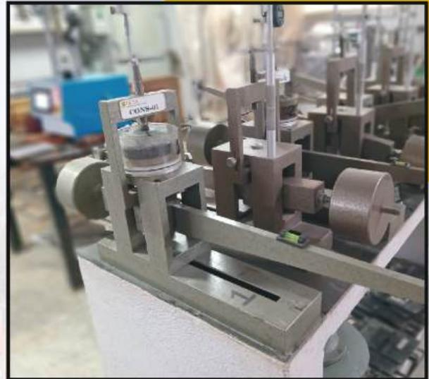
**ENSAYO DE CONSOLIDACIÓN**
