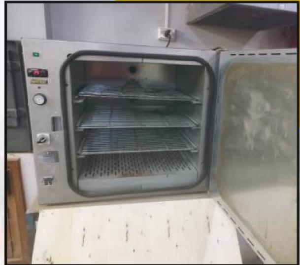
**HORNO DE SECADO ELÉCTRICO DE VENTILACIÓN FORZADA**
