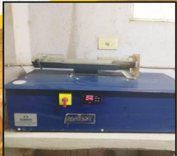
**AGITADOR ELÉCTRICO PARA EQUIVALENTE DE ARENA**
