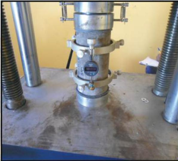
**PRUEBA DE DETERMINACIÓN DEL MÓDULO ELÁSTICO
