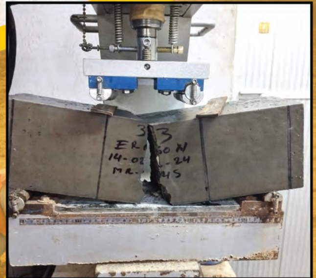
ENSAYO A FLEXIÓN EN MARCO DE CARGA PARA VIGAS DE CONCRETO
