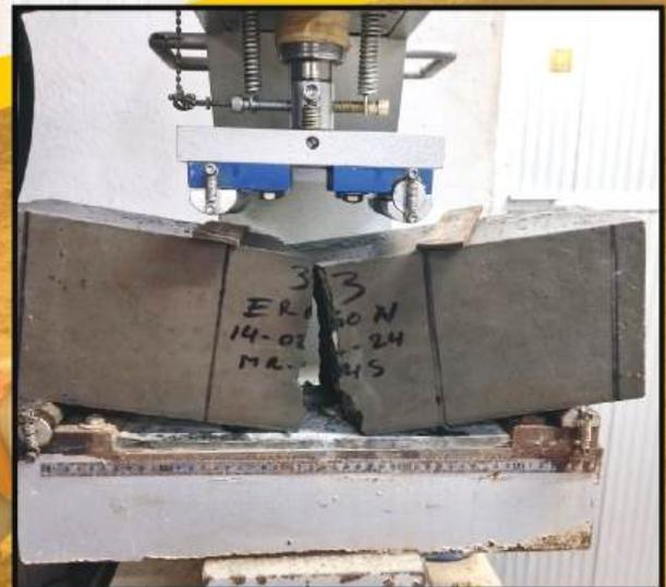
**ENSAYO A FLEXIÓN EN MARCO DE CARGA
