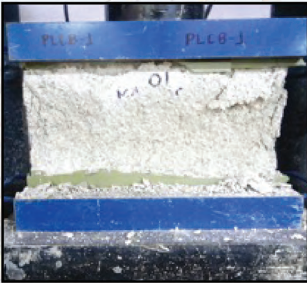
ENSAYO DE PIEZAS DE MAMPOSTERIA EN MAQUINA ELÉCTRICA
